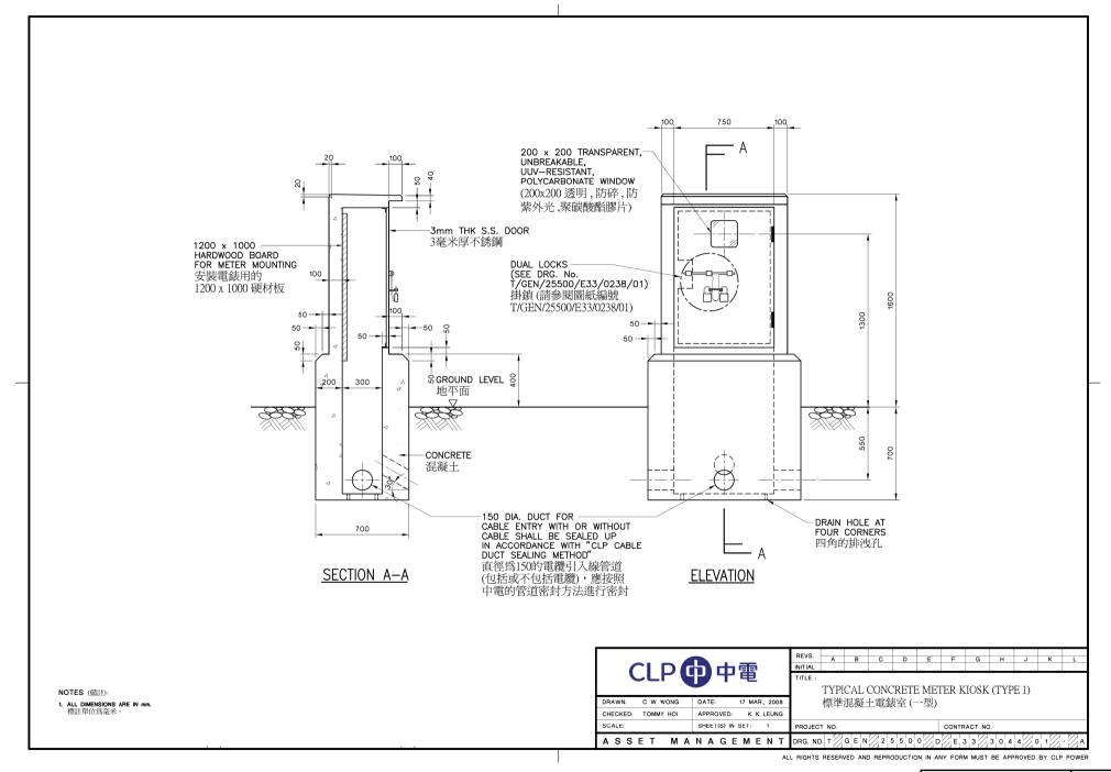
(資料來源 : 由申請人提供的標準混凝土電錶室圖) (Source : Typical Concrete Meter Kiosk Plan supplied by the Applicant) 参考編號 REFERENCE No. A/SK-CWBS/36 繪圖 DRAWING A-2
