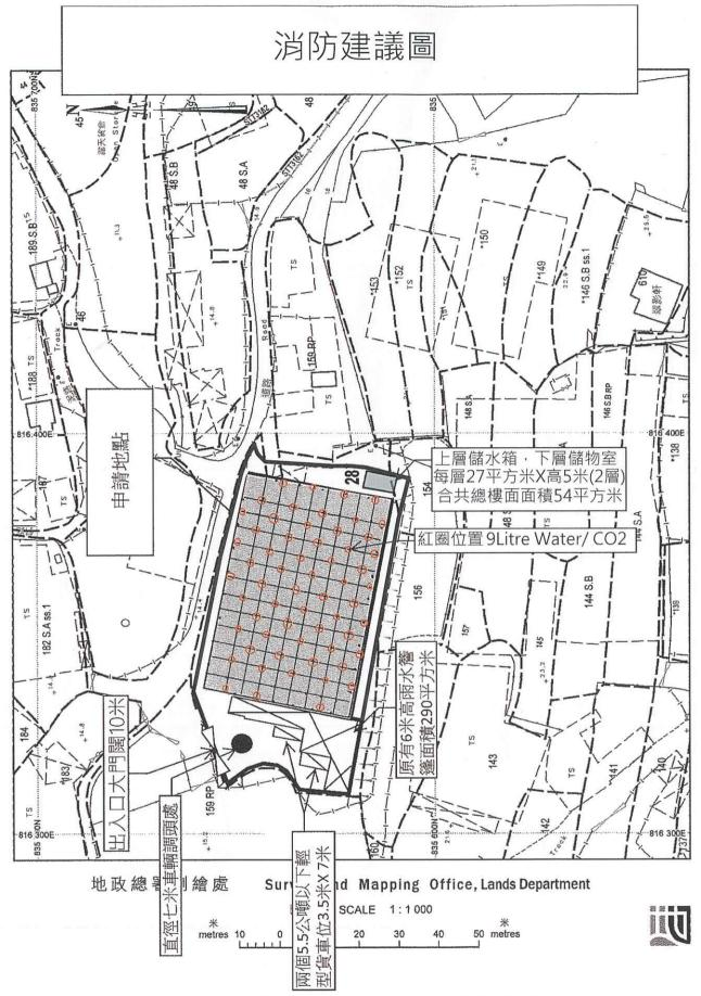
我等已在圖中紅圈位置放置合共60個 9Litre Water/CO2,以作消防設施用途 連同此圖一並附上F.S.251
