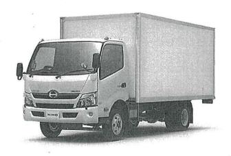
5.5 噸小型貨車,載重:1.3 噸 (包括司機及乘客), 車身長度13尺、高6尺8寸、闊6尺8寸。
